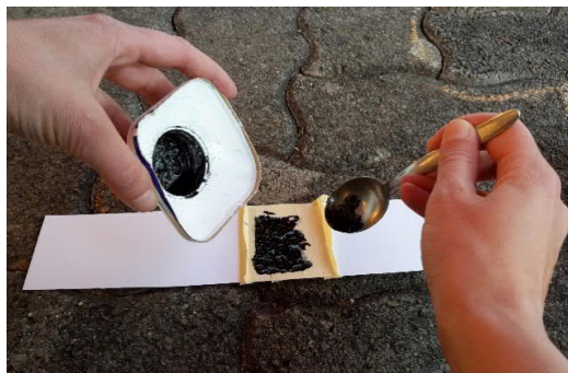
12. Möglichst viel Farbe auf das Klebband auftragen (mehrere mm dick).
